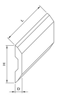
HW massiv, vorwiegend zur Bearbeitung von Hartholz, verleimten Holz und Plattenwerkstoffen
